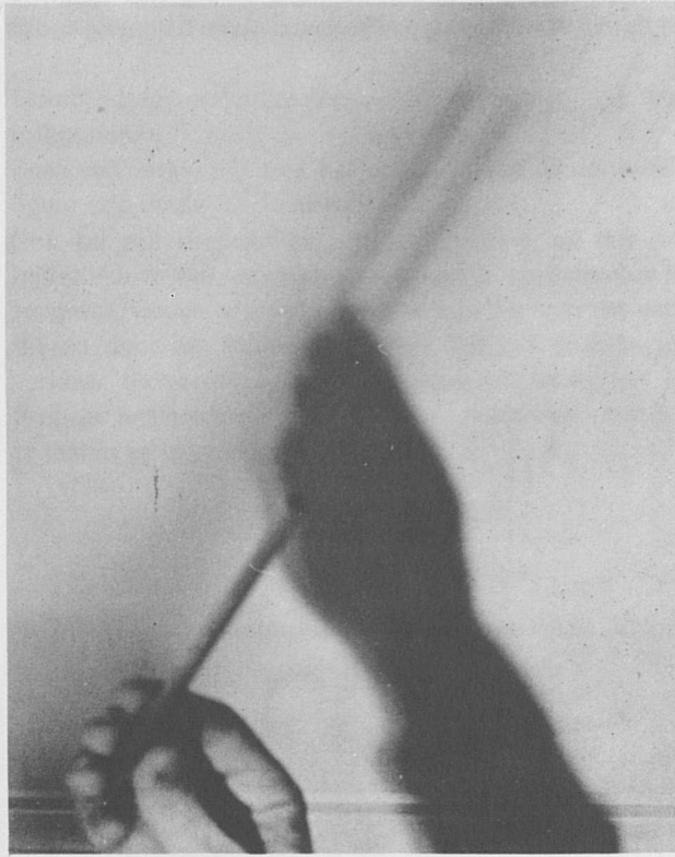
Figuur 5 Als twee halfschaduwën elkaar precies overlappen, ontstaat in het midden hiervan een lichte streep: de schaduw lijkt dubbel.
