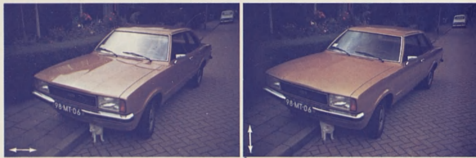
Plaat 49-50 De verschillende vlakken van een auto hebben ieder een andere polarisatie-richting (§ 48).
